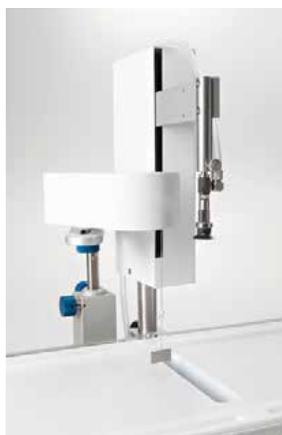
Держатель LS (Ленгмюра -Шефера) на основе большого вакуумного насоса.
